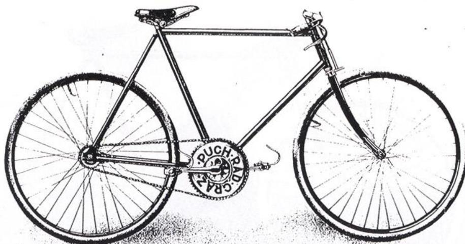
Rahmen aus feinstem Stahlrohr in der Höhe von 57, 61 und 65 cm. Innenlötung, einfache Patentfelgen, Sekunda-Gummi, Gabelkopf und Gabelenden vernickelt, einseitiges Glockenlager, Übersetzung nach Wunsch, einjährige Garantie.
